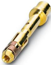
Contatto a crimpare, Femmina, tornito, diametro contatti: 1,5 mm, intervallo di crimpatura: 0,25 mm<sup>2</sup> ... 2,5 mm<sup>2</sup>, L'articolo è senza piombo secondo la direttiva RoHS II senza eccezione 6c (Pb < 0,1 %)
