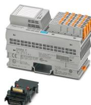
Axioline P, Modulo di ingresso digitale, Ingressi digitali: 16, 24 V DC, tecnica di connessione: 2 conduttori, velocità di trasmissione nel bus locale: 100 MBit/s, grado di protezione: IP20, compresi modulo di base bus e connettori Axioline P
