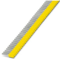
Capocorda a nastro, 1,0 mm<sup>2</sup>, lunghezza guaine 8 mm, con collare in plastica, a norma DIN 46228-4, colore speciale giallo, dotato di estremità funzionale per la lavorazione sicura e pratica con Crimphandy, 20 strisce con ciascuna 50 guaine.
