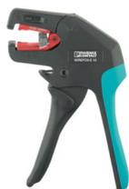
Pinza spelafili, per cavi e conduttori da 4 - 16 mm<sup>2</sup>, autoregolabile, lunghezza di spelatura fino a 18 mm, capacità di taglio fino a 10 mm<sup>2</sup> flessibile/1,5 mm<sup>2</sup> rigido, tagliacavi sostituibile
