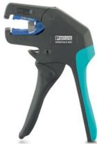
Pinza spelafili, per cavi e conduttori (in particolare anche per linee a prova di cortocircuito e di guasto verso terra) da 1,5 - 6 mm<sup>2</sup>, autoregolabile, lunghezza di spelatura fino a 18 mm, capacità di taglio fino a 10 mm<sup>2</sup> flessibile/1,5 mm<sup>2</sup> rigido, tagliacavi sostituibile
