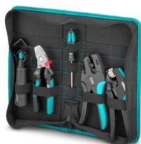
Astuccio per utensili, equipaggiato con: pinza a crimpare capicorda montati, pinza spelafili, utensile per la spelatura, tagliacavi, cacciavite ad intaglio: 0,6x3,5, borsa per utensili
