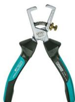
Pinza di spelatura, per spelare cavi fino a 5 mm e conduttori di max. 10 mm<sup>2</sup>, scala per misurare la lunghezza del tratto da spelare; testata secondo la norma VDE.
