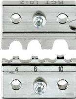
Stampo per crimpatrice CF 500, per capocorda tubolari 4 ... 10 mm<sup>2</sup>, **4 mm<sup>2</sup>**: Ø esterno 5 mm, Ø interno 3 mm, **6 mm<sup>2</sup>**: Ø esterno 6,5 mm, Ø interno 3,8 mm, **10 mm<sup>2</sup>**: Ø esterno 6 mm, Ø interno 4,5 mm
