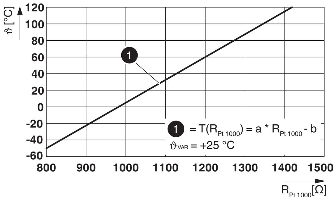
Caratteristica Pt 1000 a una temperatura ambiente pari a 25° C per il monitoraggio della temperatura sui contatti DC
