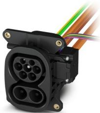
CHARX connect universal, AC/DC CCS Typ 2, Presa di ricarica del veicolo, fino a 500 A in Boost mode, 200 A permanente, 1000 V DC, 32 A , 250 V AC, Fili singoli, lunghezza: 2 m, attuatore di bloccaggio: 24 V, 4 poli, Montaggio sulla parete anteriore e posteriore, M6, custodia: nero, per la ricarica con corrente alternata (AC) e corrente continua (DC), IEC 62196-2, IEC 62196-3, La fornitura comprende un cappuccio di protezione per i contatti DC e AC.
