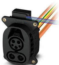
CHARX connect universal, AC/DC CCS Typ 1, Presa di ricarica del veicolo, fino a 250 A in Boost mode, 200 A permanente, 1000 V DC, 80 A , 250 V AC, Fili singoli, lunghezza: 2 m, attuatore di bloccaggio: 12 V, 4 poli, Montaggio sulla parete anteriore e posteriore, M6, custodia: nero, per la ricarica con corrente alternata (AC) e corrente continua (DC), IEC 62196-2, IEC 62196-3, La fornitura comprende un cappuccio di protezione per i contatti DC e AC.
