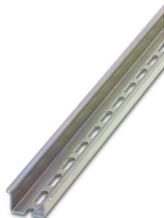
Guida di supporto forata, Variante di imballaggio con 10 pezzi (20 m), simile a norma EN 60715, materiale: Acciaio, zincato, passivato a strato spesso, Profilo standard, colore: argento
