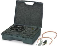
Set di messa a punto per CF 1000-1,5 dal numero di serie 160594, per capocorda montati isolati a norma DIN 46228-4: 2017-05, campo di sezione: 0,25 ... 0,34 mm<sup>2</sup>, lunghezza del tratto da spelare: 6 ... 8 mm
