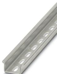
Guida di supporto forata, Variante di imballaggio con 25 pezzi (50 m), simile a norma EN 60715, materiale: Acciaio, zincato, passivato bianco, Profilo standard, colore: color argento
