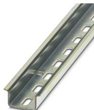
Guida di supporto forata, Variante di imballaggio con 25 pezzi (50 m), simile a norma EN 60715, materiale: Acciaio, zincato, passivato a strato spesso, Profilo standard, colore: color argento
