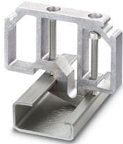
Appoggio terminale, per bloccare morsetti da UKH 50 a UKH 240, viene inserita sulla guida NS 32 e fissata con 2 viti, spessore: 10 mm, colore: alluminio
