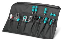
Borsa portautensili, equipaggiata con: tagliacavi, utensili di spelatura per conduttori standard da 0,08 mm<sup>2</sup> ... 16 mm<sup>2</sup>, sguainatore fino a Ø 40 mm, pinza per capocorda CRIMFOX CENTRUS 6H per conduttori da 0,14 mm<sup>2</sup> ... 6 mm<sup>2</sup>, cacciavite VDE, versione sottile, intaglio: 0,6x3,5 /0,8x4,0 /1,0x5,5, intaglio a croce: PH1/PH2/PZ1/PZ2
