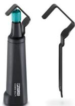
**Pinza spelafili**, per togliere il rivestim. di cavi di diametro 4,5 mm - 40 mm, spessore di isolam. fino a 4,5 mm, coltello orientabile per sezioni circolari, longit. e a spirale
