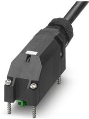
Custodia mobile, applicazione: Box sensore/attuatore, tipo di connessione: Connettore femmina M8 Metallo, numero degli slot: 8, numero poli: 3, occupazione slot: singolo, segnalazione di stato: no, Universale; connessione linea principale: Morsetto a vite estraibile 180°, PUR/PVC, lunghezza cavo: 20 m, schermatura: no
