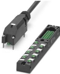
Scatola di distribuzione, applicazione: Standard, tipo di connessione: Connettore femmina M8 Metallo, numero degli slot: 8, numero poli: 4, codifica: A, occupazione slot: doppi, segnalazione di stato: sì, PNP; connessione linea principale: Morsetto a vite estraibile 180°, PUR/PVC, lunghezza cavo: 10 m, schermatura: no
