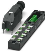
Scatola di distribuzione, applicazione: Standard, tipo di connessione: Connettore femmina M8 Metallo, numero degli slot: 8, numero poli: 3, codifica: A, occupazione slot: singolo, segnalazione di stato: sì, PNP; connessione linea principale: connessione a molla Push-in innestabile 180°, schermatura: no
