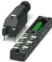
Scatola di distribuzione, applicazione: Standard, tipo di connessione: Connettore femmina M8 Metallo, numero degli slot: 6, numero poli: 3, codifica: A, occupazione slot: singolo, segnalazione di stato: sì, PNP; connessione linea principale: connessione a molla Push-in innestabile 180°, schermatura: no
