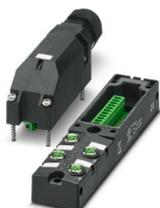
Scatola di distribuzione, applicazione: Standard, tipo di connessione: Connettore femmina M8 Metallo, numero degli slot: 4, numero poli: 3, codifica: A, occupazione slot: singolo, segnalazione di stato: sì, PNP; connessione linea principale: connessione a molla Push-in innestabile 180°, schermatura: no
