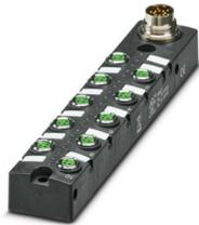
Scatola di distribuzione, applicazione: Standard, tipo di connessione: Connettore femmina M8 Metallo, numero degli slot: 10, numero poli: 3, codifica: A, occupazione slot: singolo, segnalazione di stato: sì, PNP; connessione linea principale: Connessione M16 90°, schermatura: no
