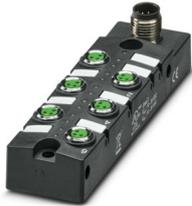
Scatola di distribuzione, applicazione: Standard, tipo di connessione: Connettore femmina M8 Metallo, numero degli slot: 6, numero poli: 3, codifica: A, occupazione slot: singolo, segnalazione di stato: sì, PNP; connessione linea principale: Connessione M12 90°, schermatura: no
