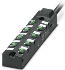
Scatola di distribuzione, applicazione: Standard, tipo di connessione: Connettore femmina M8 Metallo, numero degli slot: 8, numero poli: 3, codifica: A, occupazione slot: singolo, segnalazione di stato: sì, PNP; connessione linea principale: Attacco fisso 180°, PUR/PVC, lunghezza cavo: 3 m, schermatura: no
