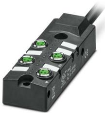
Scatola di distribuzione, applicazione: Standard, tipo di connessione: Connettore femmina M8 Metallo, numero degli slot: 4, numero poli: 3, codifica: A, occupazione slot: singolo, segnalazione di stato: sì, PNP; connessione linea principale: Attacco fisso 180°, PUR/PVC, lunghezza cavo: 5 m, schermatura: no
