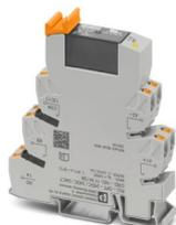
PLC-INTERFACE per funzioni di uscita, composta da morsetto base PLC-BSC.../ACT con connessione Push-in e relè a stato solido in miniatura a innesto, per il montaggio su guida DIN NS 35/7,5, 1 contatto aperto a riposo, ingresso: 24 V DC, uscita: 3 ... 33 V DC/5 A
