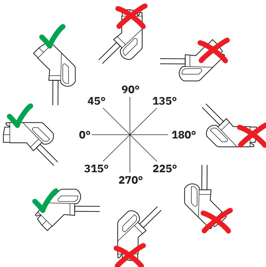
Installare i supporti di connettori della stazione di ricarica solo in modo che l'utente finale non possa inserire la spina di ricarica del veicolo capovolta (da 90° a 270°), ma solo verso l'alto (45°) o verso il basso (315°).
