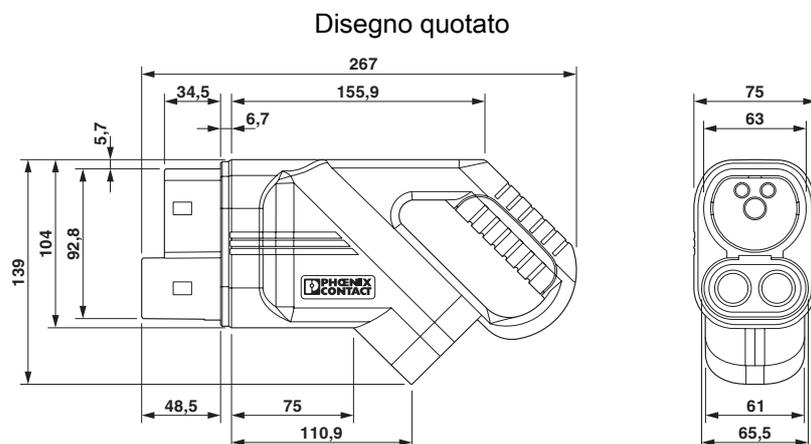
Assicurarsi che il connettore di ricarica lato veicolo sia inserito in un apposito supporto per il connettore di ricarica che garantisca una protezione di almeno IP24 secondo IEC 61851-1 durante l'intera pausa di ricarica. Per realizzare tale supporto, utilizzare le dimensioni del connettore di ricarica lato veicolo. Per informazioni più dettagliate sulle misure consultare l'area download.
