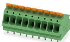
Morsetto circuito stampato, corrente nominale: 24 A, tensione di dimensionamento (III/2): 400 V, sezione nominale: 2,5 mm<sup>2</sup>, numero dei potenziali: 9, numero di file: 1, numero di poli per fila: 9, serie di prodotti: LPTA 2,5/, passo: 5 mm, tipo di connessione: Connessione Push-in con leva, montaggio: Saldatura a onde, direzione di collegamento conduttore/scheda: 30 °, colore: verde, Layout Pin: Pinning lineare, Lunghezza pin [P]: 3,5 mm, tipo di confezione: confezionato nel cartone
