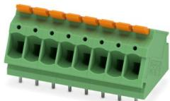
Morsetto circuito stampato, corrente nominale: 24 A, tensione di dimensionamento (III/2): 400 V, sezione nominale: 2,5 mm<sup>2</sup>, numero dei potenziali: 8, numero di file: 1, numero di poli per fila: 8, serie di prodotti: LPTA 2,5/, passo: 5 mm, tipo di connessione: Connessione Push-in con leva, montaggio: Saldatura a onde, direzione di collegamento conduttore/scheda: 30 °, colore: verde, Layout Pin: Pinning lineare, Lunghezza pin [P]: 3,5 mm, tipo di confezione: confezionato nel cartone
