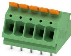
Morsetto circuito stampato, corrente nominale: 24 A, tensione di dimensionamento (III/2): 400 V, sezione nominale: 2,5 mm<sup>2</sup>, numero dei potenziali: 5, numero di file: 1, numero di poli per fila: 5, serie di prodotti: LPTA 2,5/, passo: 5 mm, tipo di connessione: Connessione Push-in con leva, montaggio: Saldatura a onde, direzione di collegamento conduttore/scheda: 30 °, colore: verde, Layout Pin: Pinning lineare, Lunghezza pin [P]: 3,5 mm, tipo di confezione: confezionato nel cartone
