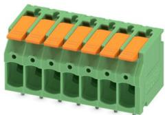
Morsetto circuito stampato, corrente nominale: 24 A, tensione di dimensionamento (III/2): 400 V, sezione nominale: 2,5 mm<sup>2</sup>, numero dei potenziali: 7, numero di file: 1, numero di poli per fila: 7, serie di prodotti: LPT 2,5/, passo: 5 mm, tipo di connessione: Connessione Push-in con leva, montaggio: Saldatura a onde, direzione di collegamento conduttore/scheda: 0 °, colore: verde, Layout Pin: Pinning lineare, Lunghezza pin [P]: 3,5 mm, tipo di confezione: confezionato nel cartone
