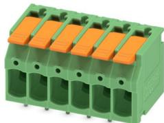
Morsetto circuito stampato, corrente nominale: 24 A, tensione di dimensionamento (III/2): 400 V, sezione nominale: 2,5 mm<sup>2</sup>, numero dei potenziali: 6, numero di file: 1, numero di poli per fila: 6, serie di prodotti: LPT 2,5/, passo: 5 mm, tipo di connessione: Connessione Push-in con leva, montaggio: Saldatura a onde, direzione di collegamento conduttore/scheda: 0 °, colore: verde, Layout Pin: Pinning lineare, Lunghezza pin [P]: 3,5 mm, tipo di confezione: confezionato nel cartone
