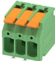
Morsetto circuito stampato, corrente nominale: 24 A, tensione di dimensionamento (III/2): 400 V, sezione nominale: 2,5 mm<sup>2</sup>, numero dei potenziali: 3, numero di file: 1, numero di poli per fila: 3, serie di prodotti: LPT 2,5/, passo: 5 mm, tipo di connessione: Connessione Push-in con leva, montaggio: Saldatura a onde, direzione di collegamento conduttore/scheda: 0 °, colore: verde, Layout Pin: Pinning lineare, Lunghezza pin [P]: 3,5 mm, tipo di confezione: confezionato nel cartone
