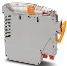
Modulo fusibile per elementi di base VIP I/O-Marshalling con fusibile da 0,25 A sostituibile nel percorso di alimentazione del dispositivo da campo. I punti di prova integrati e un coltello sezionatore consentono di misurare il segnale ininterrottamente.
