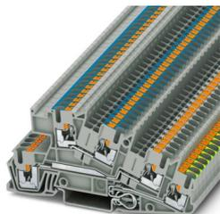
Morsetto per conduttore di terra per installazione, tensione nominale: 400 V, corrente nominale: 24 A, Connessione Push-in, 1., 2. e 3. piano, Sezione di dimensionamento: 2,5 mm<sup>2</sup>, sezione: 0,14 mm<sup>2</sup> - 4 mm<sup>2</sup>, tipo di montaggio: NS 35/7,5, NS 35/15, colore: grigio
