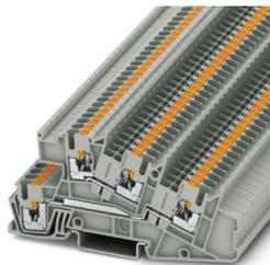
Morsetto di installazione a più piani, tensione nominale: 400 V, corrente nominale: 24 A, Connessione Push-in, 1., 2. e 3. piano, Sezione di dimensionamento: 2,5 mm<sup>2</sup>, sezione: 0,14 mm<sup>2</sup> - 4 mm<sup>2</sup>, Connessione Push-in, tipo di montaggio: NS 35/7,5, NS 35/15, colore: grigio
