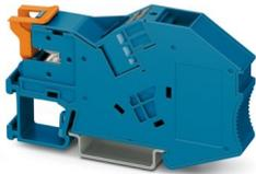
Morsetto per installazioni, con blocco posizione, tensione nominale: 1000 V, corrente nominale: 70 A, Connessione Push-in, 1. piano, Sezione di dimensionamento: 16 mm<sup>2</sup>, sezione: 0,5 mm<sup>2</sup> - 25 mm<sup>2</sup>, tipo di montaggio: NS 35/7,5, NS 35/15, colore: blu
