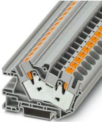
Morsetto per installazioni, tensione nominale: 500 V, corrente nominale: 76 A, Connessione Push-in, 1. piano, Sezione di dimensionamento: 16 mm<sup>2</sup>, sezione: 0,5 mm<sup>2</sup> - 16 mm<sup>2</sup>, tipo di montaggio: NS 35/7,5, NS 35/15, colore: grigio
