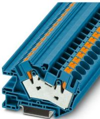
Morsetto per installazioni, tensione nominale: 500 V, corrente nominale: 76 A, Connessione Push-in, 1. piano, Sezione di dimensionamento: 16 mm<sup>2</sup>, sezione: 0,5 mm<sup>2</sup> - 16 mm<sup>2</sup>, tipo di montaggio: NS 35/7,5, NS 35/15, colore: blu
