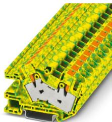
Morsetto per conduttore di terra per installazione, tensione nominale: 500 V, corrente nominale: 76 A, Connessione Push-in, 1. piano, Sezione di dimensionamento: 16 mm<sup>2</sup>, sezione: 0,5 mm<sup>2</sup> - 16 mm<sup>2</sup>, tipo di montaggio: NS 35/7,5, NS 35/15, colore: giallo-verde
