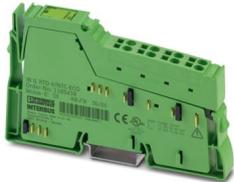
Inline, Modulo di rilevamento della temperatura, Ingressi RTD analogici: 4 (NTC, resistenze lineari), tecnica di connessione: 2 conduttori, velocità di trasmissione nel bus locale: 500 kBit/s, grado di protezione: IP20, Connettori Inline compresi
