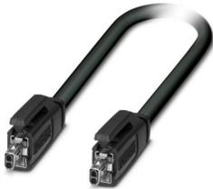
Cavo patch, tipo: IEC 63171-2, grado di protezione: IP20, lunghezza cavo: 1 m, numero poli: 2, 1 Gbit/s, CAT B, materiale: TPU, tipo di connessione: Connessione a crimpare, sezione di connessione: AWG 22- 22, uscita cavo: diritto, Single Pair Ethernet
