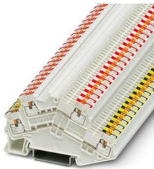
Morsetto a due piani, per bus KNX nell'installazione in edifici, confezionamento in coppie (25 coppie = 50 pezzi), tensione nominale: 500 V, corrente nominale: 16 A, tipo di connessione: Connessione Push-in, 1. e 2. piano, Sezione di dimensionamento: 1,5 mm<sup>2</sup>, sezione: 0,14 mm<sup>2</sup> - 1,5 mm<sup>2</sup>, tipo di montaggio: NS 35/7,5, NS 35/15, colore: bianco
