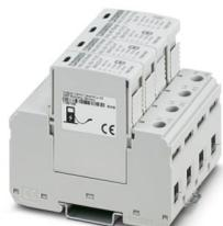
CHARX protect advanced, scaricatore di sovratensione / fulmini, conf. al tipo 1/2 / Class I/II, per reti di alimentazione di corrente trifase con N e PE separati (sistema a 5 conduttori: L1, L2, L3, N, PE). Particolarmente indicato per l'utilizzo nella mobilità elettrica.
