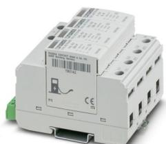
CHARX protect basic, scaricatore di sovratensione a innesto, conf. a tipo 2 / Class II, per reti di alimentazione di corrente trifase con N e PE separati (sistema a 5 conduttori: L1, L2, L3, N, PE) con contatto di segnalazione remota. Particolarmente indicato per l'utilizzo nella mobilità elettrica.
