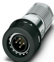
Connettore, Universale, 5-poli, schermata, Maschio diritto M12 Bloccaggio esterno Push-Pull, codifica: A, Connessione a crimpare, materiale zigrinato: PA 6.6, diametro esterno conduttore 6,5 mm ... 10 mm, senza contatti a crimpare
