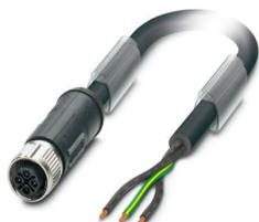
Cavo di alimentazione, 3-poli, PUR senza alogenati, nero, estremità conduttore libera, su Connettore femmina diritto M12, codifica: S, lunghezza cavo: 2 m, per corrente alternata fino a 16 A/690 V
