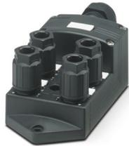
Scatola di distribuzione, tipo di connessione: QUICKON, 0,14 mm<sup>2</sup> ... 0,75 mm<sup>2</sup>, numero degli slot: 4, numero poli: 5, occupazione slot: doppi, segnalazione di stato: no, Universale; connessione linea principale: Connessione Push-in 180°, schermatura: no, Con il collegamento di 5 conduttori sono collegabili max. 0,5 mm<sup>2</sup>
