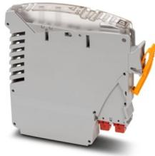
Ostacolo Ex-ic non-incendive per elementi di base VIP I/O-Marshalling. Per limitare la corrente (60 mA o 80 mA) e la tensione (26,4 V DC) alle uscite digitali. Ad esempio, per il controllo di valvole elettromagnetiche nelle zone a potenziale rischio di esplosione (zona 2, CID2).
