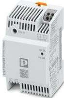
Alimentazione switching, STEP POWER, Connessione Push-in, Montaggio su guida DIN o diretto, ingresso: 1 fase, uscita: 12 V DC / 5 A, regolabile da 9 V DC ... 17 V DC
