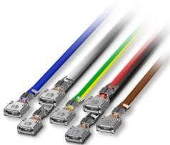
CHARX connect modular, Tipo 2, Set di cavi per prese di ricarica lato infrastruttura, 20 A , 480 V AC, Accessori, Fili singoli, lunghezza: 0,3 m, Montaggio a innesto, con spina femmina Faston su un lato, esclusivamente per la connessione alle prese di ricarica lato infrastruttura di seconda generazione di Phoenix Contact, IEC 62196-2
