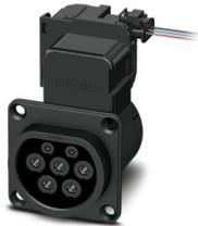
CHARX connect modular, Tipo 2, Presa di ricarica lato infrastruttura, 32 A , 480 V AC, Premium, senza fili singoli, attuatore di bloccaggio: 12 V, 3 poli, squadrato, Montaggio sulla parete posteriore, Filettatura M5, custodia: nero, con sensori di temperatura, con LED (collegamento catodo in comune), per la ricarica con corrente alternata (AC) di veicoli elettrici (EV), Logo PHOENIX CONTACT, IEC 62196-2
