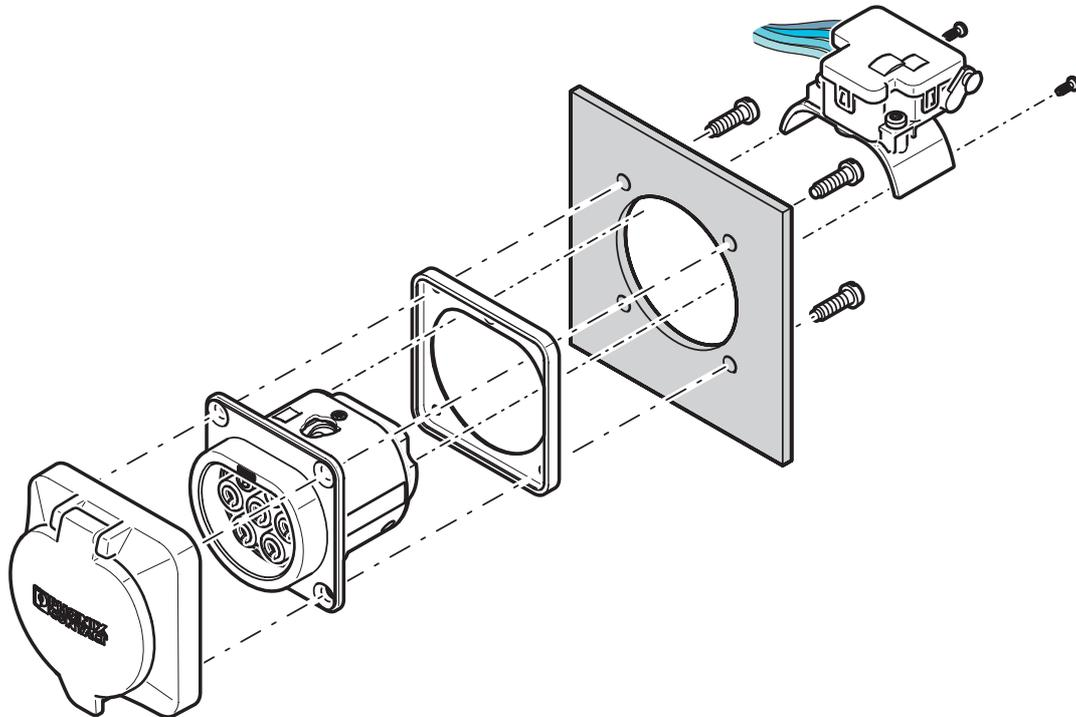
Montaggio a parete anteriore con collegamento a vite del coperchio di protezione sul lato posteriore
