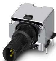
Connettori per circuiti stampati SPE, tipo: IEC 63171-5, grado di protezione: IP65/IP67, numero poli: 2, CAT B (ISO/IEC 63171), materiale: Metallo, tipo di connessione: Attacco a saldare THR, Single Pair Ethernet
