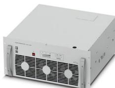
CHARX power basic, Modulo di ricarica rapida per la realizzazione di stazioni di ricarica DC, ingresso: 3 fase, uscita: 200 V DC...920 V DC / 125 A. Per il funzionamento del modulo di potenza DC è necessario il rispettivo quadro elettrico di sistema CHARX PS-CAB/4x87.5KW (cod. art 1165442)
